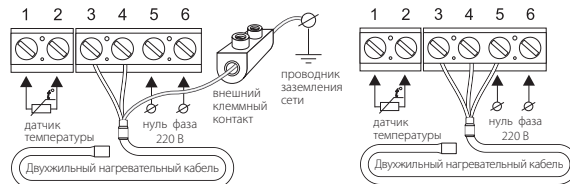
Схема подключения к 3-х проводной электрической сети
